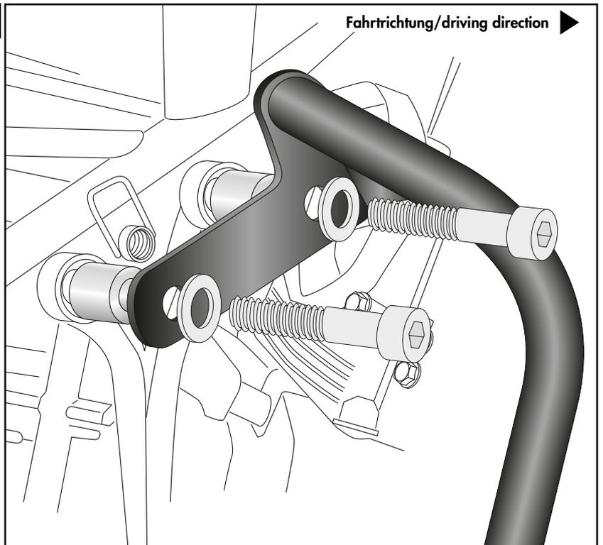
**Montage Motorschutzbügel unten rechts:**
