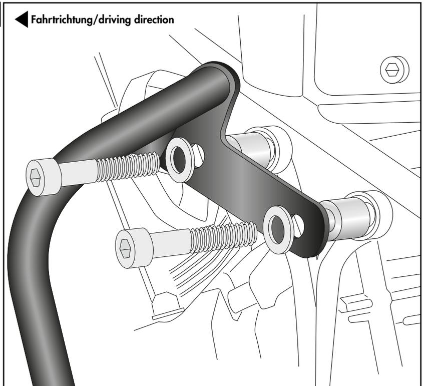
**Montage Motorschutzbügel oben rechts:**
