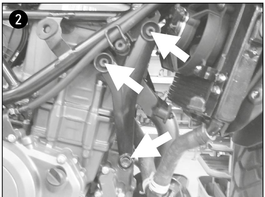
**Montage Motorschutzbügel oben links:**
