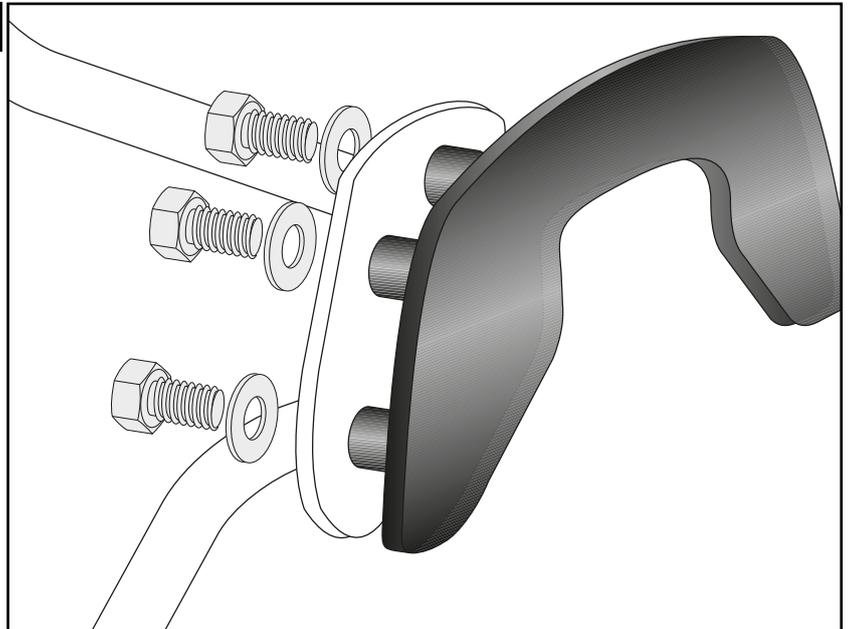
**Nach der Montage alle Verschraubungen auf festen Sitz kontrollieren! Abgebaute Teile wieder montieren.
