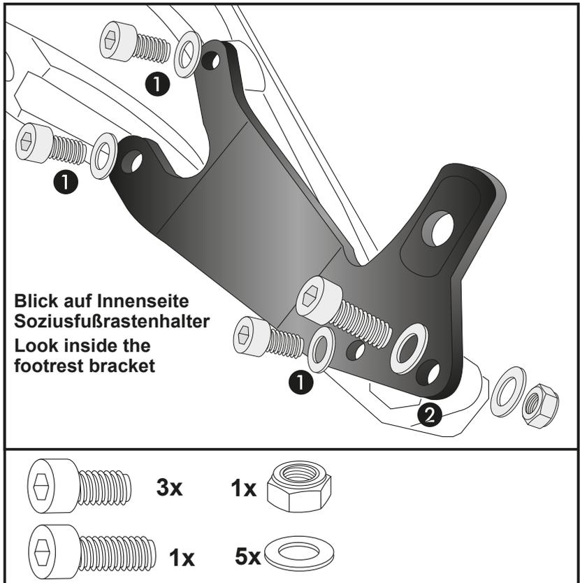
**5** Befestigung Halteadapter unten links: Soziusfußrasten demontierten. Der Halteadapter wird an der Innenseite montiert. Am oberen und am mittleren Befestigungspunkt den Adapter an den Gewindebohrungen mit den Zylinderschraube M8x16 sowie U-Scheibe Ø8,4 verschrauben. ① Am unteren Befestigungspunkt an der Durchgangsbohrung mit der Zylinderschraube M8x30 sowie U-Scheiben Ø8,4 und selbstsichernder Mutter M8 verschrauben. ② Fußrastenhalter wieder montieren.
