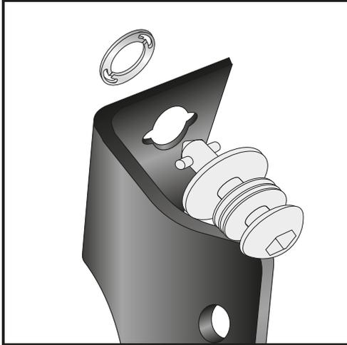
**6** Montage der Lock-it System-Schrauben:
