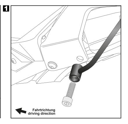
Montage des Halter hinten rechts/links: Die Montage erfolgt in den nun freien Gewindebohrungen mit den Inbusschrauben M6x40.
