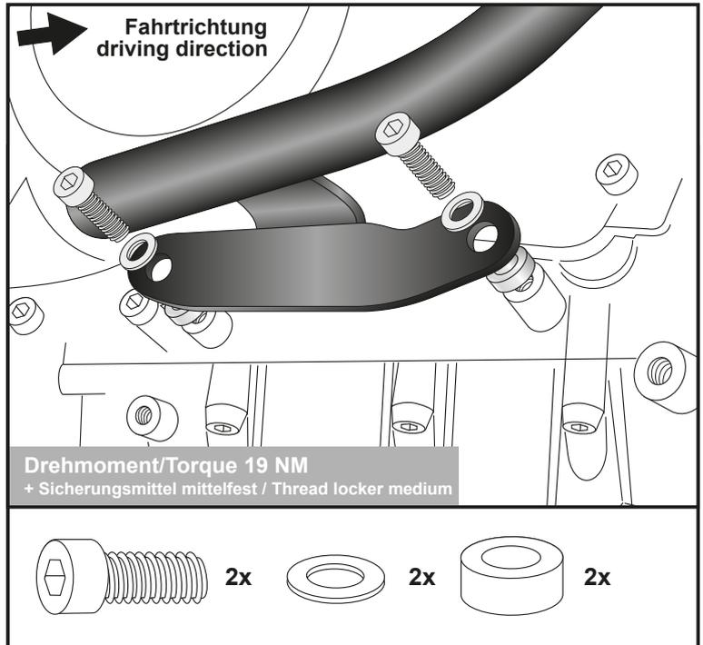
**Montage des linken Motorschutzbügels vorne:**
