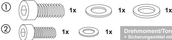
**Drehmoment/Torque 19 NM**
