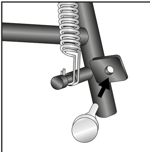
**4** Die Feder wird an der dafür vorgesehenen Aufnahme am Hauptständer eingehängt.
